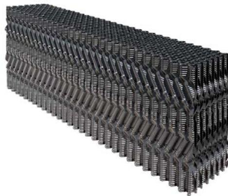
Поверх пленочного оросителя ОП-21 устанавливаются сетчатые блоки капельного оросителя типа ПР-50 высотой 50 мм. Это решение улучшит распределение воды, будет способствовать ускоренному формированию тонкой пленки воды, а также защит ороситель ОП-21 от направленного не распыленного потока воды.
